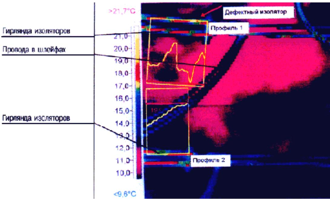
На профиле 2 показано распределение температуры по гирлянде при исправных изоляторах: имеет место плавное повышение температуры к изолятору, примыкающему к проводу фазы.
