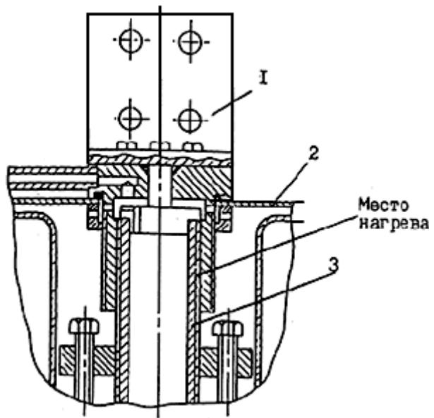
**Рис.3-31. Верхний зажим ввода МВ-110/1000 (заводской чертеж № 132-0-0):**
