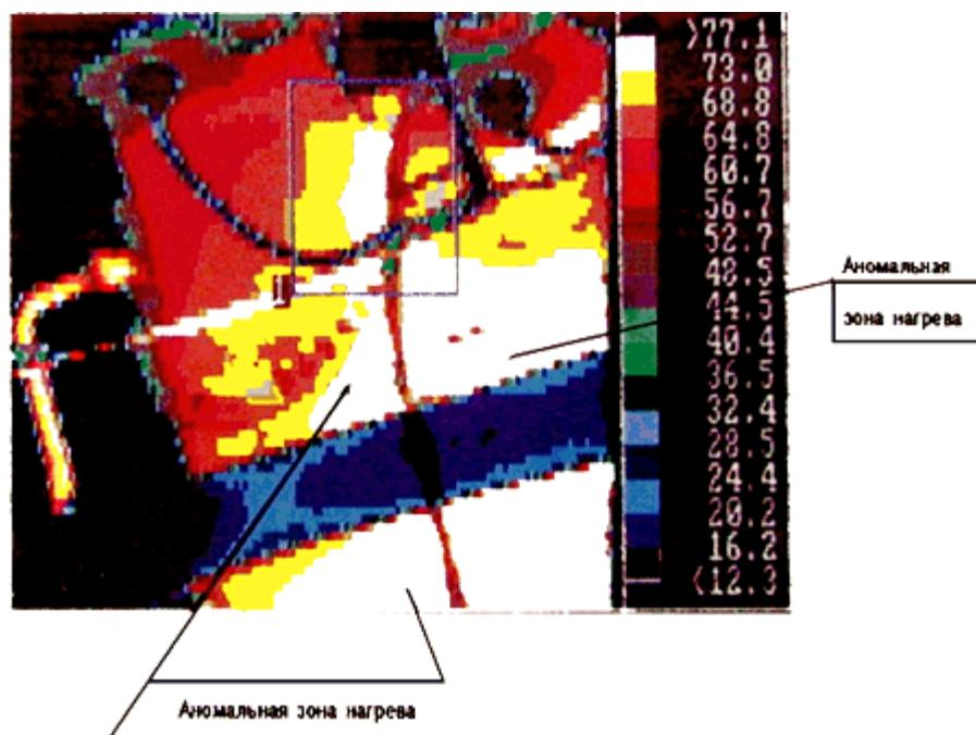
Фрагмент поверхности бака со стороны обмотки 500 кВ
