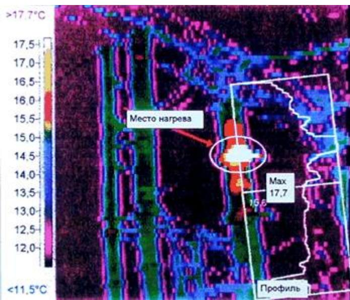
Ослабление контактного соединения второй и третьей (сверху) дугогасительных камер выключателя ВВ-500 кВ привело к аварийному нагреву этого узла.
