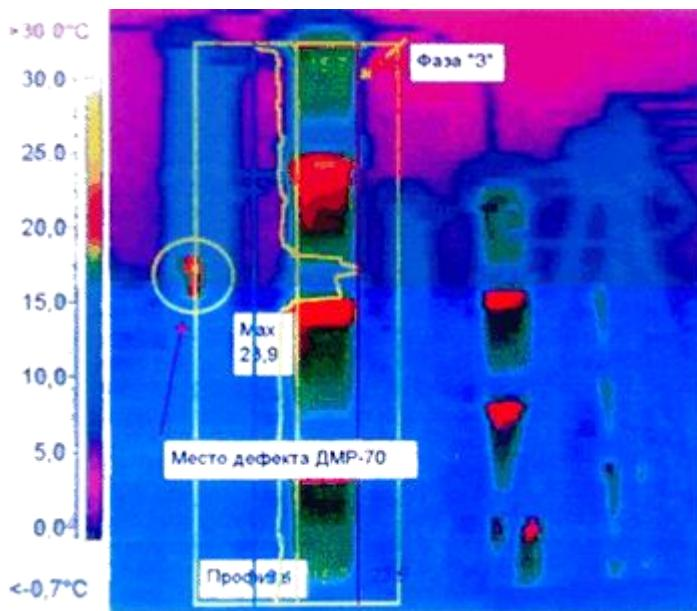
Трансформаторы этого типа состоят из четырех установленных в колонку элементов, каждый из которых зашунтирован конденсатором ДМР-70. На термограмме видно, что второй элемент конденсатора сверху имеет внутри секцию с повышенными диэлектрическими потерями, что подтверждает построенный термопрофиль.
