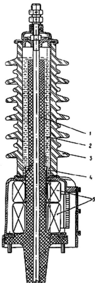
1 - литая эпоксидная втулка; 2 - виниловый заполнитель; 3 - покрышка; 4 - место скопления влаги; 5 - трансформаторы тока
