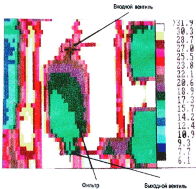
Температура на входе масла в фильтр - 21,9 °C; на выходе - 17,1 °C.
