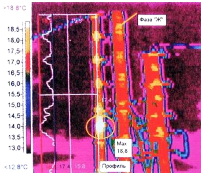
Неудовлетворительная герметизация фарфоровой покрышки воздуховода отделителя ВВ-500 кВ привела к увлажнению внутренней поверхности покрышки, протеканию по ней тока утечки, нагреву и последующему перекрытию.
