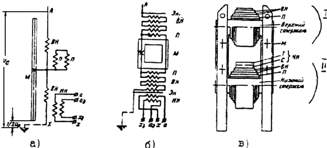
Рис.3-45. Трансформаторы напряжения 110 кВ:
