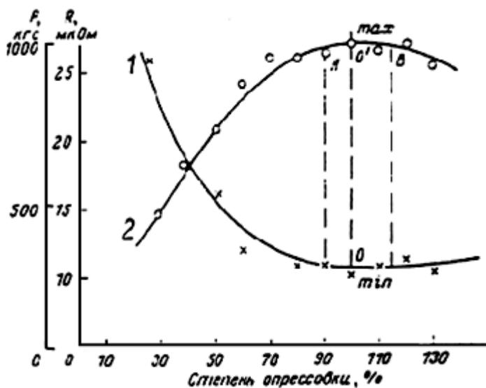
Зависимость контактного сопротивления (1) и механической прочности (2) соединения от степени опрессовки.
