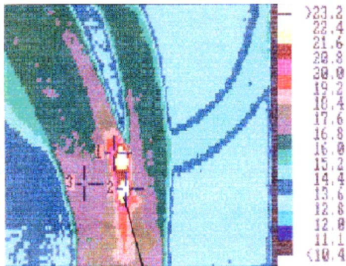
Видны очаги внутреннего разрушения (с нагревом) изоляции между фазами (зона 1). Съемка проводилась тепловизором со спектральным диапазоном 8-12 мкм.
