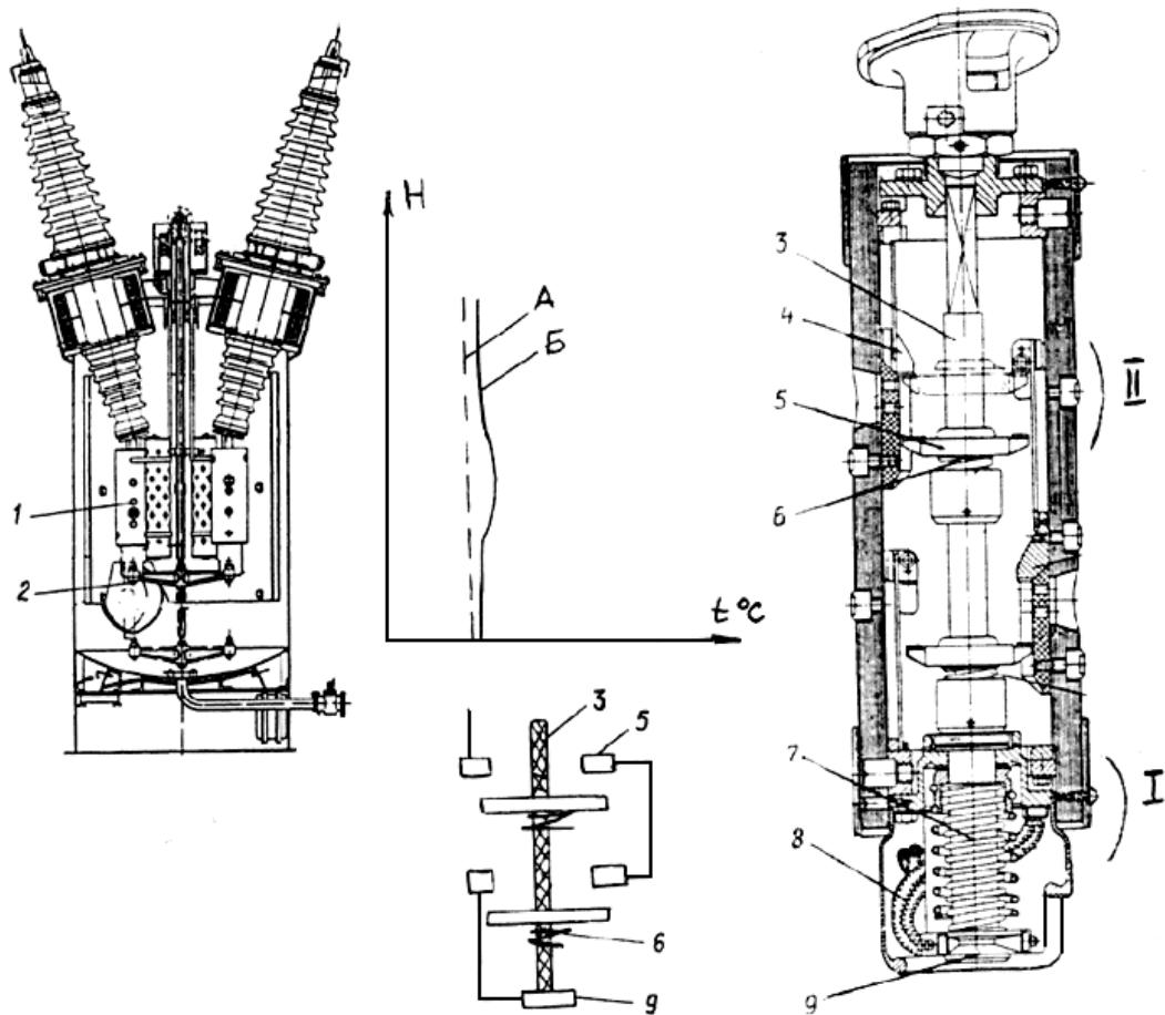
**Рис.3-13. Выключатель МКП-110М:**
