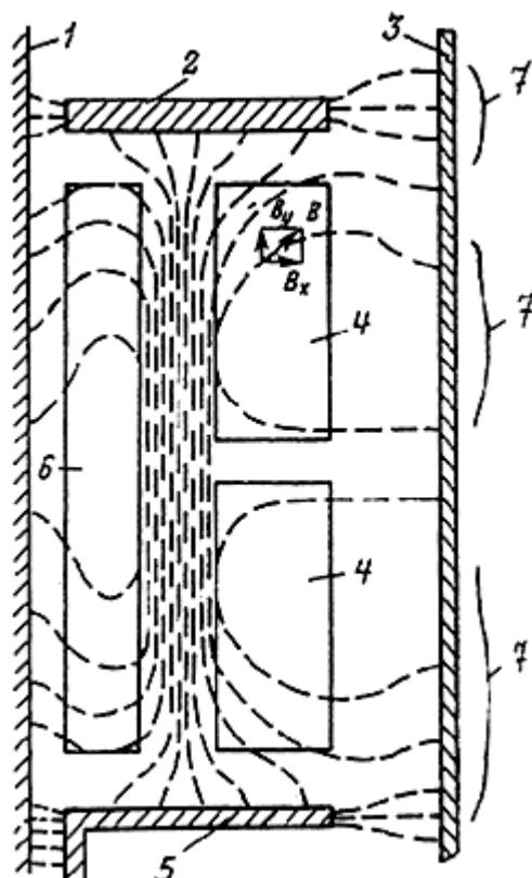
**Рис.3.4. Картина поля рассеяния в двухобмоточном трансформаторе:**
