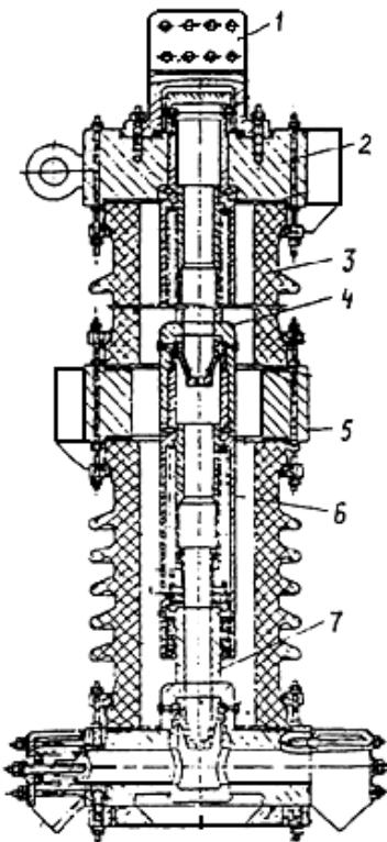
**Гасительная камера воздушного выключателя серии ВВН:**
