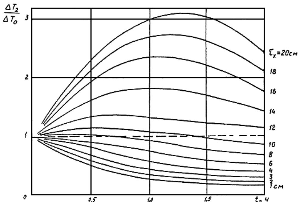
Рис.3-1. График определения глубины залегания очага нагрева
