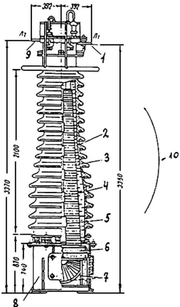
**Рис.3-25. Конструкция трансформатора тока ТФКН-330:**
