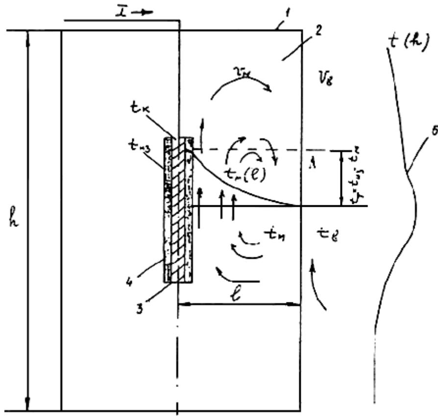
**Рис.3-21. Термовая модель токоведущего контакта в масле:**
