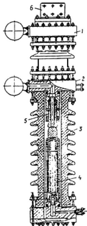
**Воздухонаполненный изолатор воздушного выключателя серии ВВН:**
