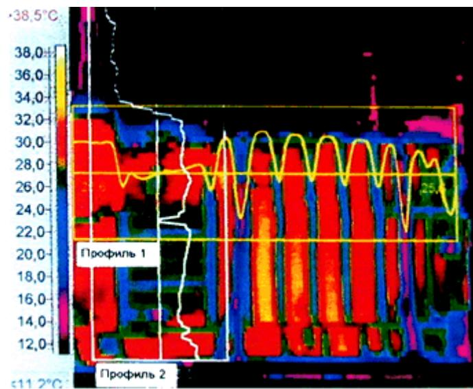
Распределение температуры по высоте (профиль 2) и горизонтали (профиль 1) бака АТ-2 показывает, что внутренних дефектов теплового характера в баке нет
