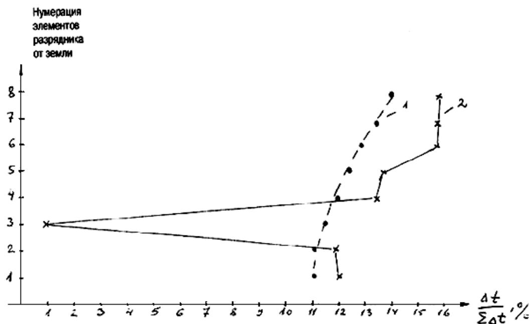
**Рис.3-43. Распределение температуры по элементам разрядника РВМГ-330:**
