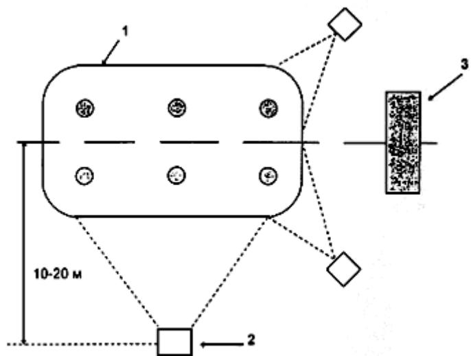
**Рис.3-5. План термографической съемки трансформатора**
