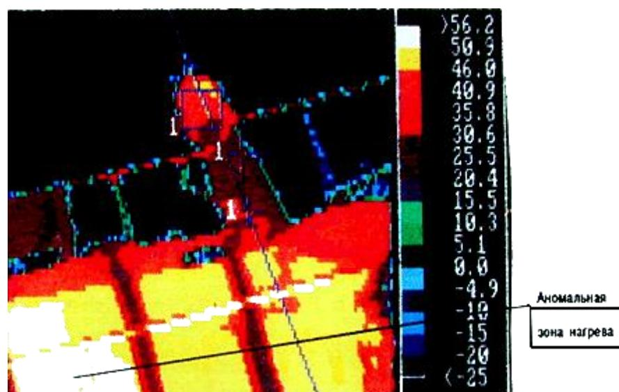
Фрагмент поверхности бака со стороны обмотки 220 кВ
