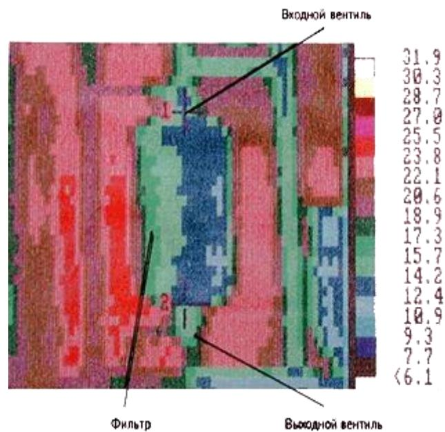
Температуры на входе масла в фильтр и выходе из него практически одинаковы и находятся в пределах 14,3-14,5 °C, что характеризует отсутствие протока масла через фильтр.
